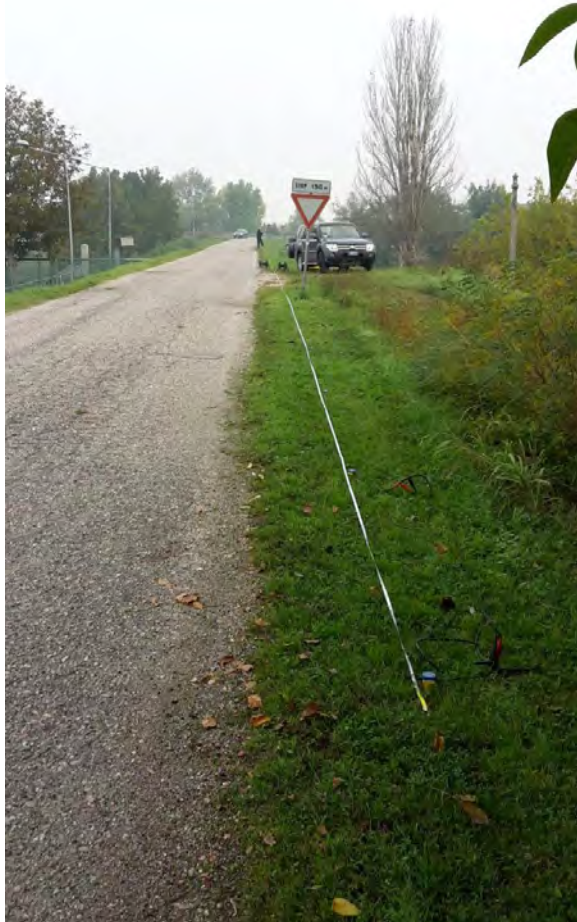
Acquisizione Remi-MASW 1 eseguita in sponda sinistra del Fiume Mincio – Vista verso nord
