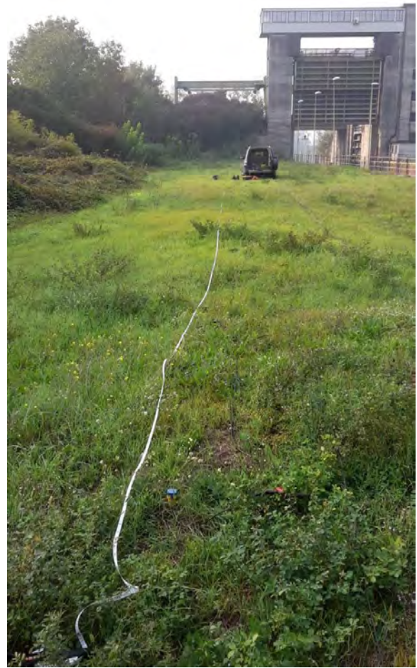
Acquisizione Remi-MASW 2 eseguita in sponda sinistra del Canal Bianco – Vista verso sud
