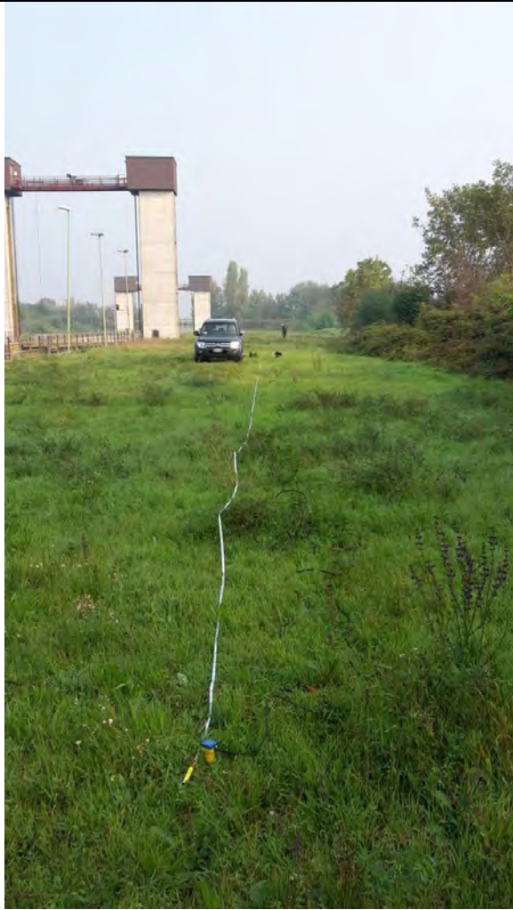
Acquisizione Remi-MASW 2 eseguita in sponda sinistra del Canal Bianco – Vista verso nord
